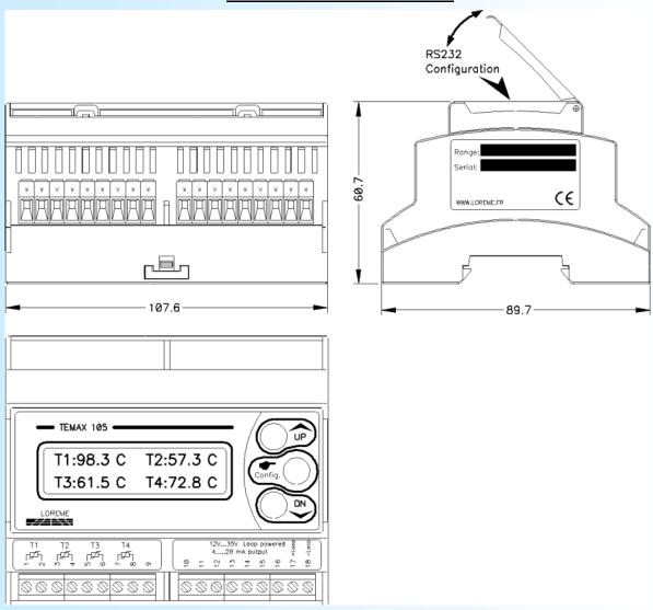
Voie 1 entrée PT100 2 fils:Borne 1 , Borne 2Voie 2 entrée PT100 2 fils:Borne 3 , Borne 4Voie 3 entrée PT100 2 fils:Borne 5 , Borne 6Voie 4 entrée PT100 2 fils:Borne 7 , Borne 8
