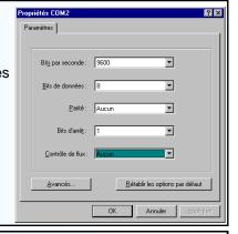
6 Le PC est en mode terminal, le relier à l'appareil en branchant le cordon RS232. La mesure est visualisée à l'écran. Pour entrée en configuration, taper sur "C" au clavier.
